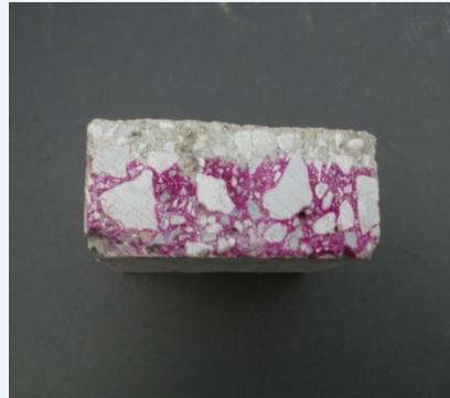
Ciascuna superficie di rottura fresca è stata trattata con una soluzione indicatrice a base di fenolftaleina che colora in rosa-violetto le zone non carbonatate e lascia incolori quelle carbonatate.
