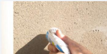
La prova è terminata con la chiusura dei fori eseguiti per i prelievi utilizzando un apposito stucco per cemento ad asciugatura rapida.
