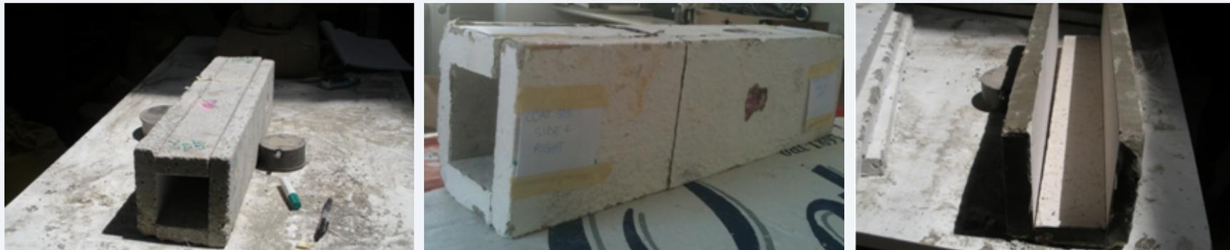
*Immagini delle lastre rimosse dalle superfici laterali di un provino prismatico non protetto (a sinistra), un provino prismatico protetto con la finitura acrilica AC 515 (al centro) ed un provino prismatico protetto con il rivestimento cementizio CM 519 (a destra).*
