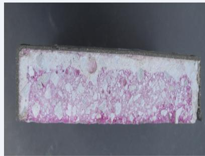
*Foto dei campioni sottoposti a test con fenolftaleina estratti rispettivamente dal provino UNC (in alto), dal provino AC 515 (al centro) e dal provino CM 519 (in basso), con dettaglio di una misurazione.*
